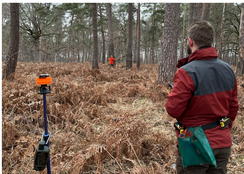
Photo ci-contre : Mesures en cours sur une placette à angle fixe. L'opérateur au premier plan saisit les informations indiquées par l'opérateur de mesure situé au centre de la photo (au loin). Le centre de la placette est matérialisé par le piquet bleu à gauche de la photo.
